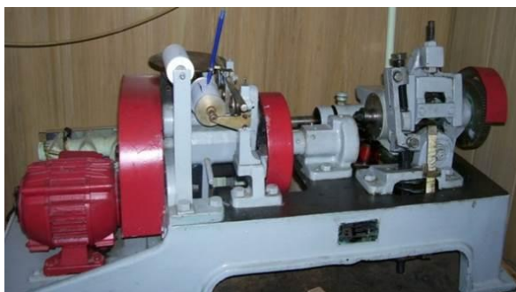
Рисунок 2. Машина трения МИ-1М
