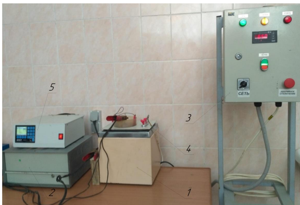
Рисунок 1. Лабораторная ультразвуковая гальваническая установка
