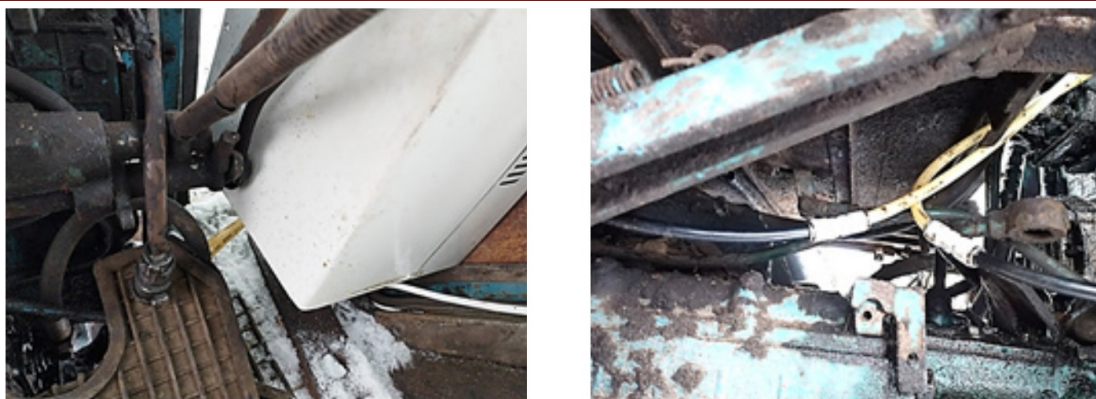
Рисунок 1. Врезка устройства СВЧ обработки в топливную систему дизеля Д-243
