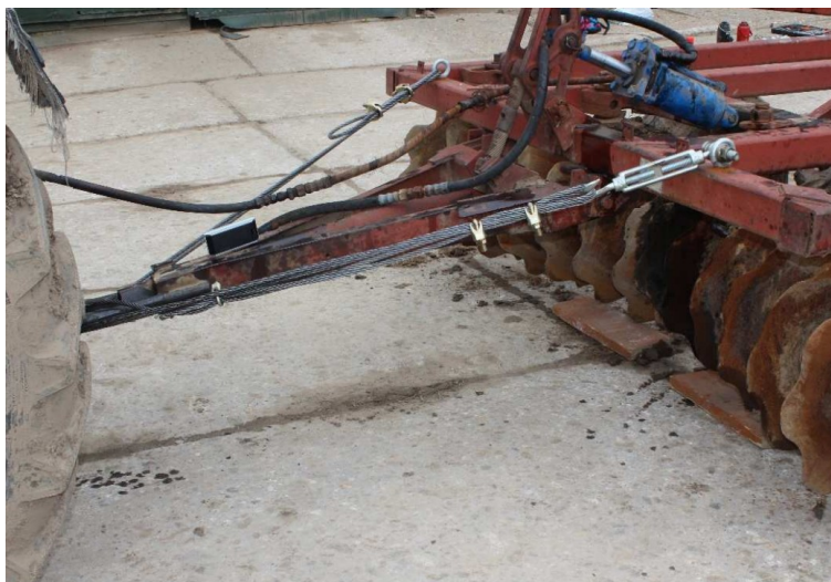
Рисунок 4. Общий вид МТА с устройством для перераспределения нагрузки между движителями энергетического средства и бороной БДТ-3
