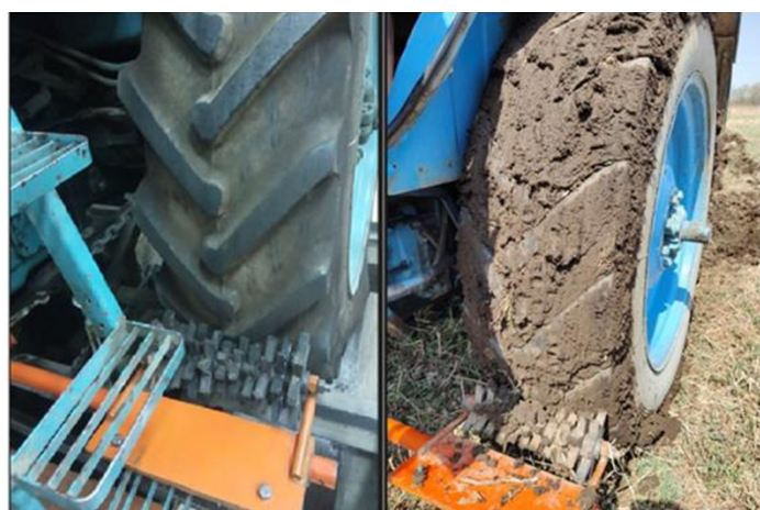
Рисунок 3. Установка и производственное применение комбинированного очистителя протектора колёсного движителя.
