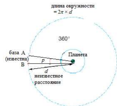
Рисунок 1.2 Вычисление расстояний с использованием параллакса
