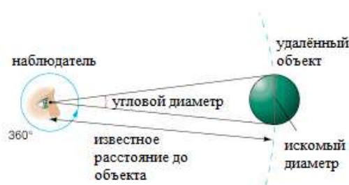
Рисунок 1.3 Определение линейных размеров удалённого объекта
